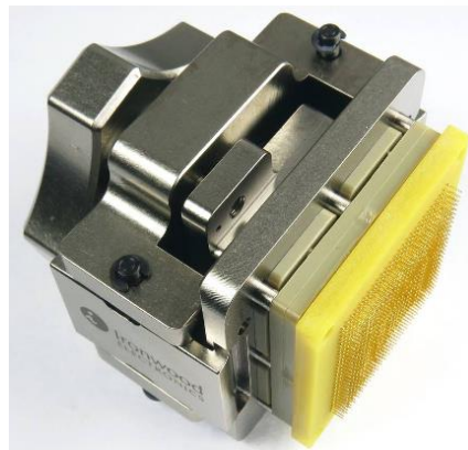
クラムシェルソケットにスルーホールアダプタを取り付けたところ
